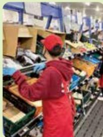
ピッキングの指示は、棚ランプの点滅によって瞬時に判断します。
