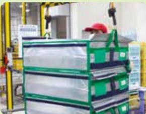
輸送用の大型保冷容器を積み付けロボットによって積み上げます。
