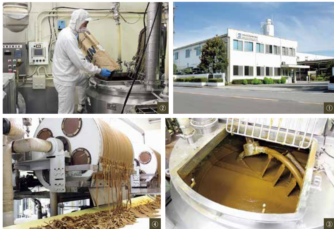
①平和食品工業株式会社工場 ②小麦粉投入の様子 ③かくはん機で混合 ④独自の「急速冷却ドラム成型機」 でルウをフレーク状に加工
